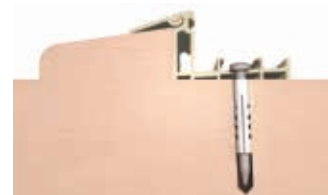
Fixation en rénovation
