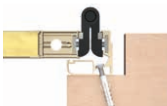
Pose en feuillure
