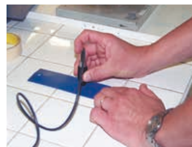
Contrôle de l'épaisseur du thermolaquage
