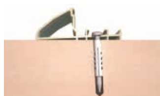
Fixation en neuf sur sol plat seuil standard
