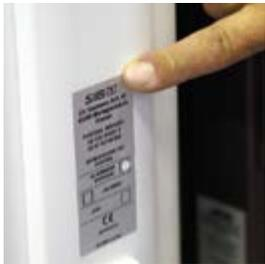
Etape de contrôle en fin de montage : chaque commande est validée avant emballage du produit. Le contrôleur va vérifier l'aspect dimensionnel, les coloris, options, fonctionnement des organes, apposer le marquage NF-CE attestant de la conformité du matériel livré. En cas d'anomalie, le matériel est réintégré dans le processus de fabrication pour modification.
