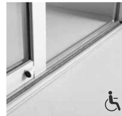
**SEUIL RÉDUIT** : ATLANTEM EST LE PREMIER FABRICANT À PROPOSER EN OPTION, UN SEUIL RÉDUIT NON ENCASTRÉ ADAPTÉ AUX NORMES PMR (PERSONNES À MOBILITÉ RÉDUITE), SUR UN COULISSANT PVC, ULTRA FIN (20 mm), POSÉ FACILEMENT ET SANS DÉCAISSEMENT, IL ASSURE UNE PARFAITE ISOLATION GRÂCE À SA RUPTURE DE PONT THERMIQUE TOUT EN GARANTISSANT UNE EXCELLENTE ÉTANCHÉITÉ À L'EAU ET À L'AIR
