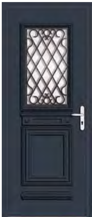
SMITH Bleu canon, mouluration rapportée 2 faces, cimaise et jet d'eau extérieur, poignée plaque Nova inox, vitrage dépoli avec grille incorporée.
