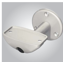
Fixation main courante / mur Entraxe maxi 1500 mm
