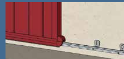
Réglette support en partie basse pour porte-fenêtre
