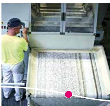
La matière est micronisée, broyée et revalorisée sous forme de granulés.
