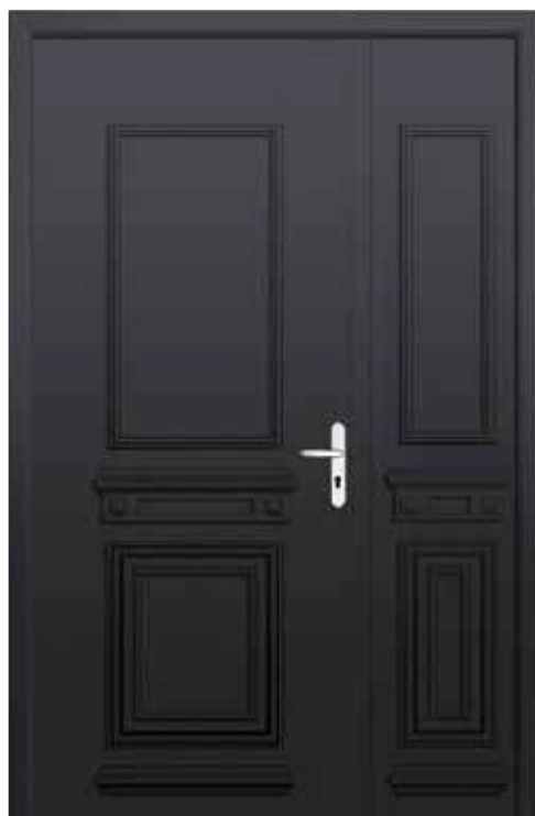
ATKINS + SEMI-FIXE RAL 7016, mouluration rapportée 2 faces, cimaise et jet d'eau extérieur, poignée plaque Nova inox.
