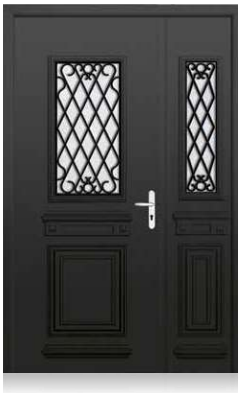
SMITH + SEMI-FIXE (vitrée avec grille incorporée). RAL 7016, mouluration rapportée 2 faces, cimaise et jet d'eau extérieur, poignée plaque Nova inox, vitrage dépoli avec grille incorporée.
