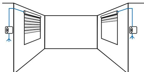
Adapté pour un seul volet roulant à motoriser, le moteur est relié au point de commande par un câblage électrique.
