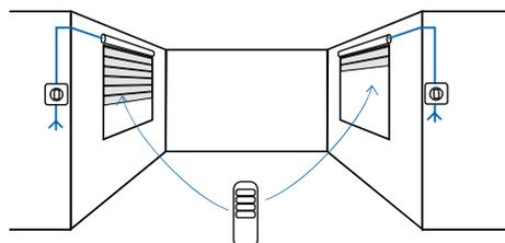
C'est un moteur qui se pilote d'un point de commande mural filaire et par une commande mobile ou par un smartphone. Il permet de respecter l'esthétique des points de commande de la maison.
