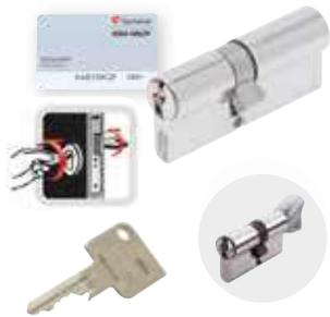
**BARILLET VMI+** avec fonction clé de secours, très résistant au crochetage, 5 goupilles en acier trempé. Clé de forte section (3 mm) à perçage latéral, offrant une bonne prise en main, barillet fourni avec carte de propriété 4 clés
