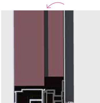
**Écran acoustique** de 5 mm d'épaisseur en option pour renforcer les performances phoniques : **jusqu'à 33 dB** pour un modèle plein (Sauf porte d'entrée cintrée).
